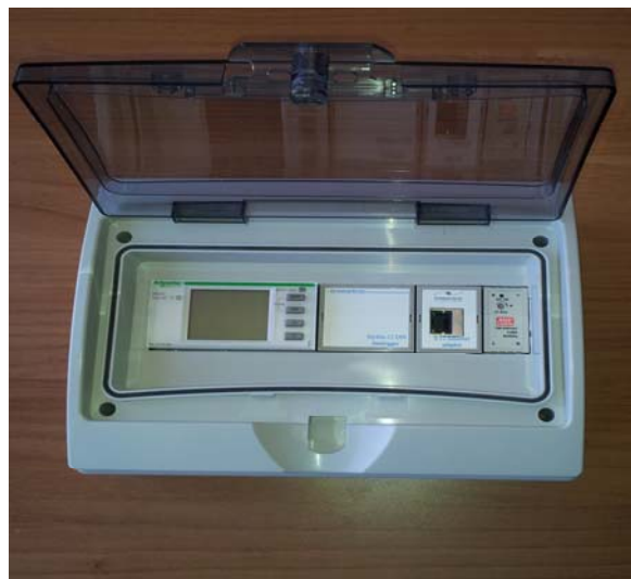
Σύστημα ράγας DIN με πολύοργανο, καταγραφικό, μονάδα Ethernet και τροφοδοτικό
